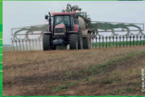
Tonne à pendillards permettant de limiter la volatilisation de l'azote ammoniacale au cours de l'épandage
